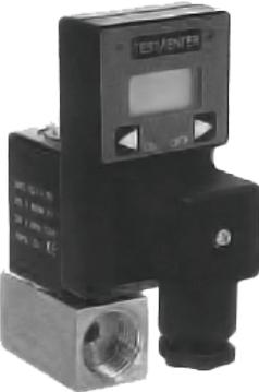
Клапаны серии FD применяются для автоматического сброса конденсата из ресиверов и в автоматических ирригационных системах. Данные клапаны снабжены электронными таймерами, подающими сигналы на их открытие. Таймеры, установленные на клапанах, позволяют регулировать длительность и период между сигналами на открытие. Клапаны серии FD имеют надежную конструкцию, увеличенный диаметр условного прохода и большой диапазон рабочих давлений.
